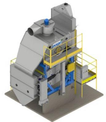
El propósito de la máquina de prelimpieza y limpieza de cereales, se enfoca en eliminar el mayor número posible de impurezas para brindar un buen secado y / o almacenamiento, siendo uno de los equipos de fundamental importancia en las unidades de almacenamiento de granos, así como aumentar la calidad de granos almacenados, reducen el consumo de energía de las secadoras.
